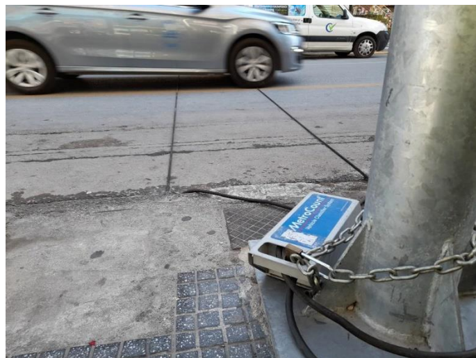
Εικόνα 34: Εγκατάσταση αυτόματου μετρητή κυκλοφορίας σε διατομή καταγραφής κυκλοφοριακών φόρτων
